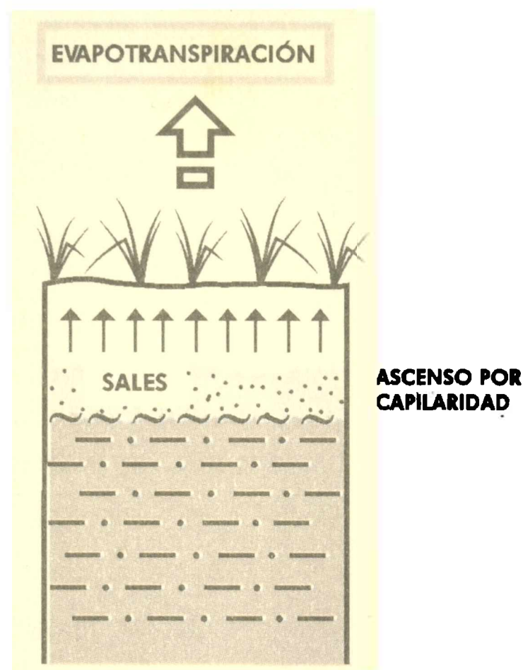
Figura 2. Salinización. Ascenso de solución salina por capilaridad (primera fase)
