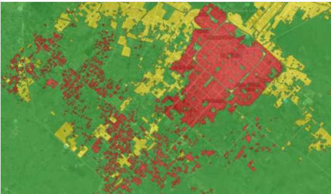
Figura 18: Niveles de impermeabilización en el territorio analizado. Impermeabilización alta (rojo), impermeabilización media (amarillo) e impermeabilización baja (verde)
