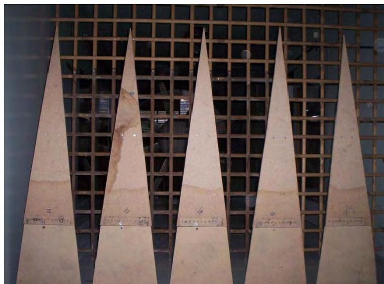
Figura 3: Sistema de simulación de baja energía turbulenta en las pequeñas escalas
