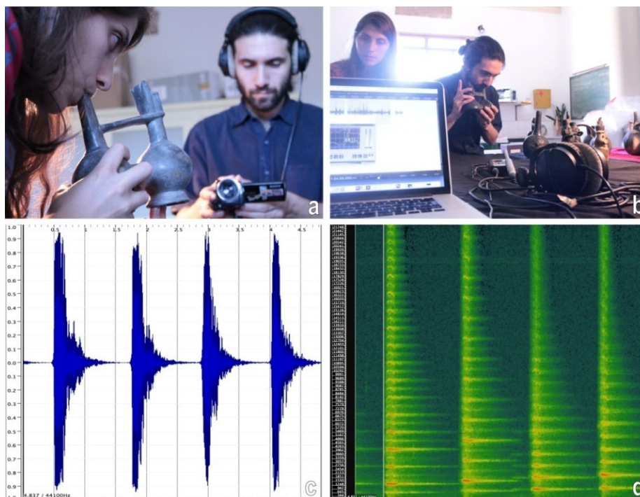
Figura 3. Mediciones acústicas de los originales. a) y b) Dos momentos del trabajo de filmación, registro y medición del sonido de las piezas originales. c) y d) Formas de onda y sonogramas obtenidas de la pieza (MLP-Ar-781).
