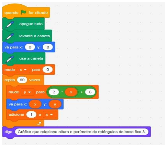
Figura 2. Comandos para esboço do gráfico do perímetro de um retângulo de base 3 e altura variável.
