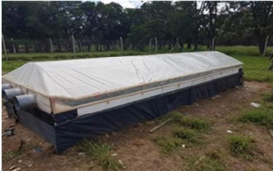
Figura 2: Vista del secadero solar compacto
