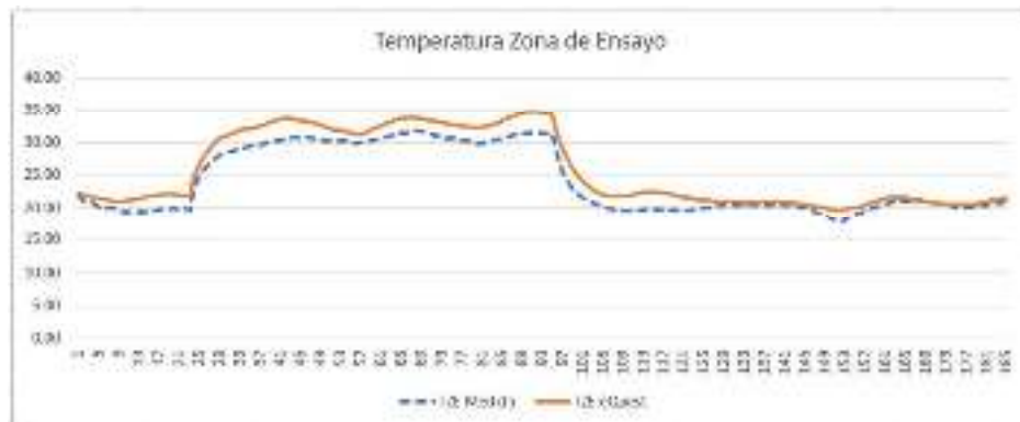
Figura 9: Temperaturas en la Zona de Ensayo
