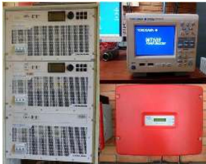
Figura 3 – Simulador de módulos Fotovoltaicos, analizador de energía e inversor.
