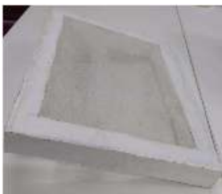
Figura 2: Vistas del colector de acetato con doble lámina: posee una lámina de acetato en la parte superior y otra en la parte inferior.
