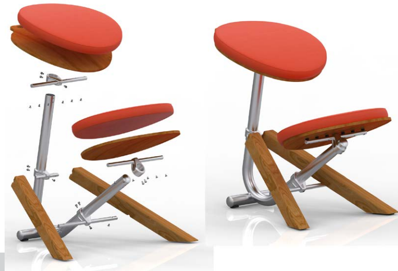
Figura 3. Perspectiva explotada: despiece que permite ver componentes y cómo se ensamblan
