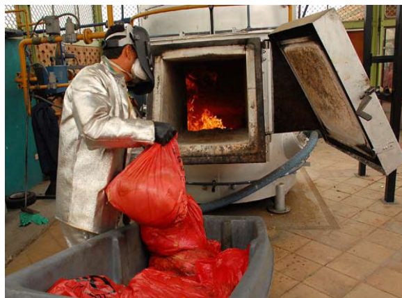
Figura No. 7. Aquí se muestra un horno incinerador y eliminación final de RPBI, así como vestimenta usada y medidas de bioseguridad por el trabajador de la empresa externa.
