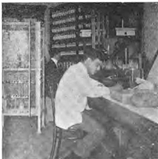
Fig. 7. Determinando el peso del hectólitro.
