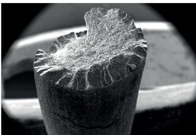
*Observación de fisuras mediante microscopía óptica.*
