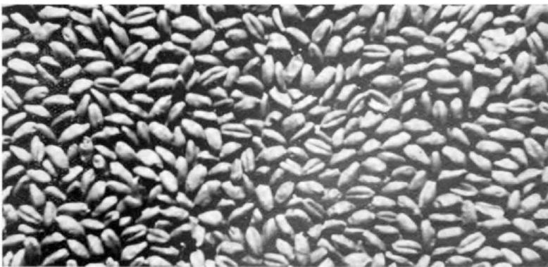
**Muestra obtenida de una clasificadora de discos. La uniformidad no es tan apreciable como en la muestra anterior**
