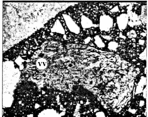
Fm10. Vulcanita vitrea (vv) con avanzado proceso de desvitrificación principalmente a montmorillonita
