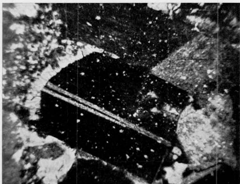
Fig. 2. — Esquisto cuarcítico-sillimanítico . Nícoles cruzados. Aumento : \times 30
