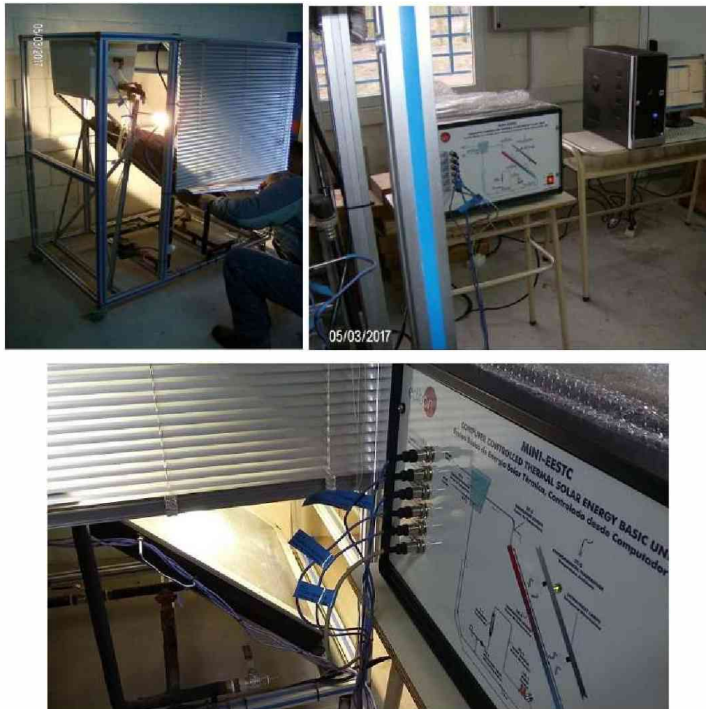
Figura 2: Ensayos iniciales del equipo MiniEESTC (arriba) y Tablero operativo (abajo)
