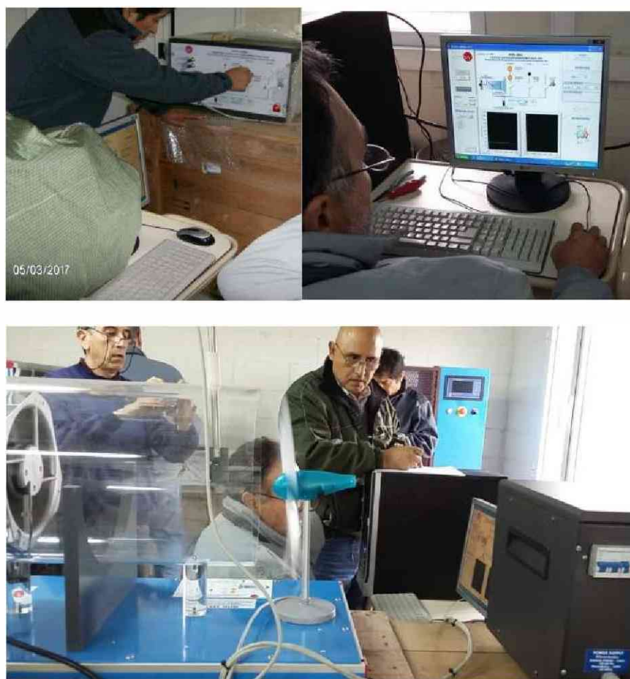
Figura 4: Ensayos iniciales del equipo e interfaz MINI-EEE/EEEC (arriba) y vista en operación (abajo)
