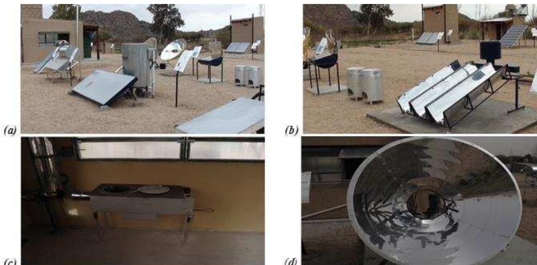
Figura 3: Aparatos e instalaciones del módulo cocina
