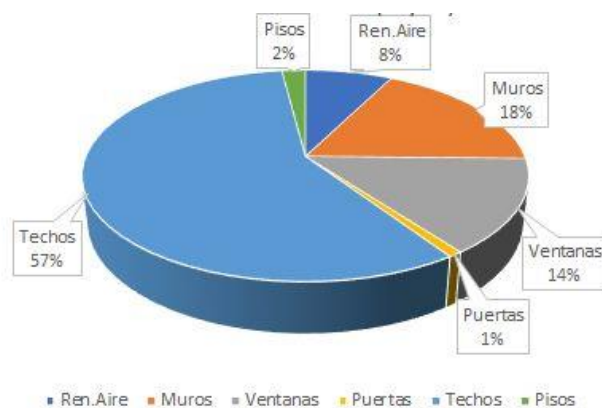
Figura 1: Pérdidas térmicas en calefacción, discriminadas. Situación original.
