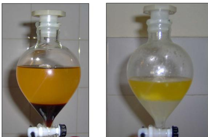
Figura 1 – Etapas de separación (izq.) y lavado del biodiesel (der.).
