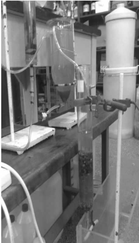
Prototipo del mecanismo de abatimiento de arsénico.
