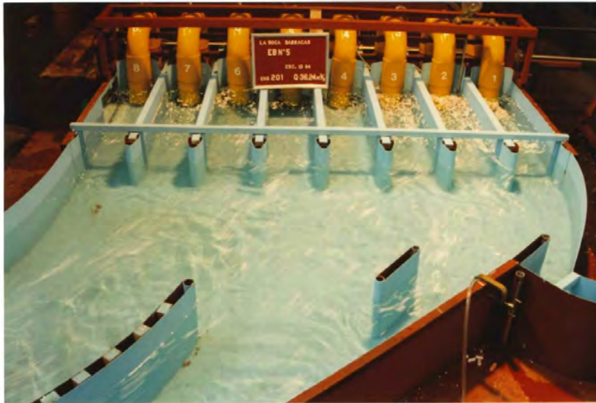
Figura 6.17: Modelación física de la Estación de Bombeo número 5 del sistema de protección La Boca-Barracas, construido por la UIDET-Hidromecánica de la Universidad Nacional de La Plata
