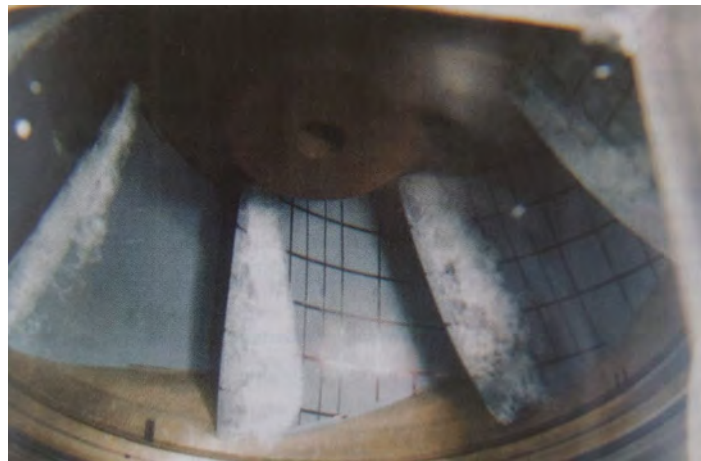
Figura 4.3: Cavitación en borde de ataque de una bomba centrífuga (fuente: La cavitation, Mécanismes physiques et aspects industriels, 1995., Presses Universitaires de Grenoble)
