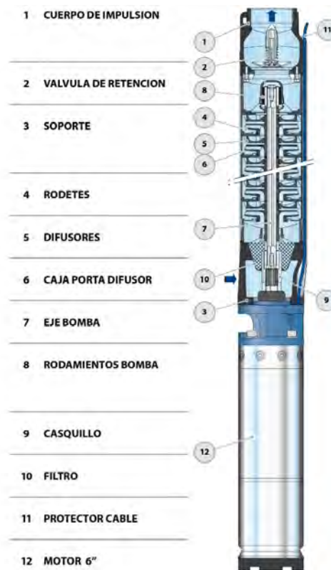
Figura 2.29: Disposición en serie: bomba sumergida, multietapa (fuente: Catálogos Pedrollo https://www.pedrollo.com/ )
