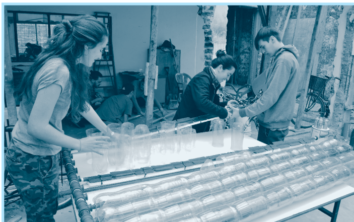
Alumnos de Ingeniería ensamblando botellas para el calefón solar
