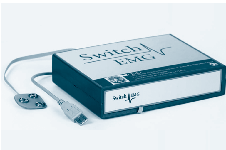
Aparato desarrollado en el LEICI: Adquisidor de electromiograma
