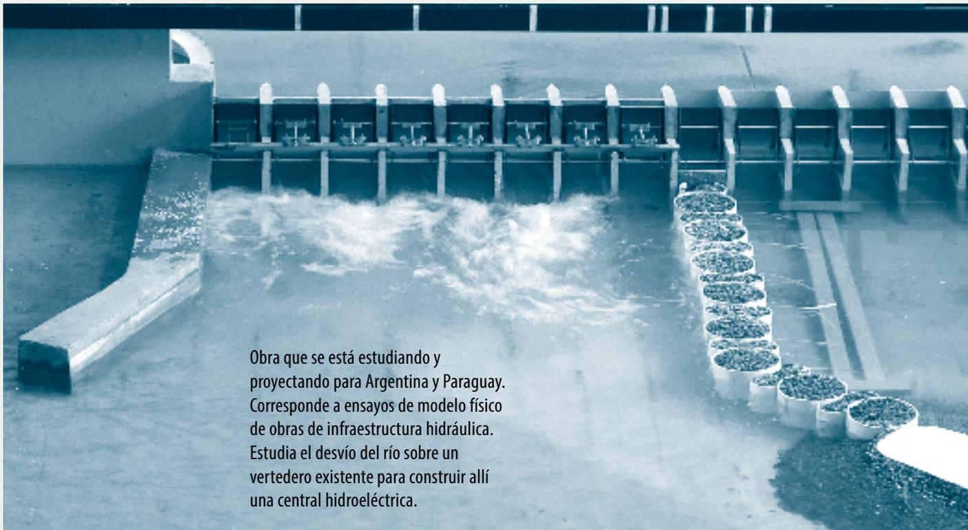
Obra que se está estudiando y proyectando para Argentina y Paraguay. Corresponde a ensayos de modelo físico de obras de infraestructura hidráulica. Estudia el desvío del río sobre un vertedero existente para construir allí una central hidroeléctrica.
