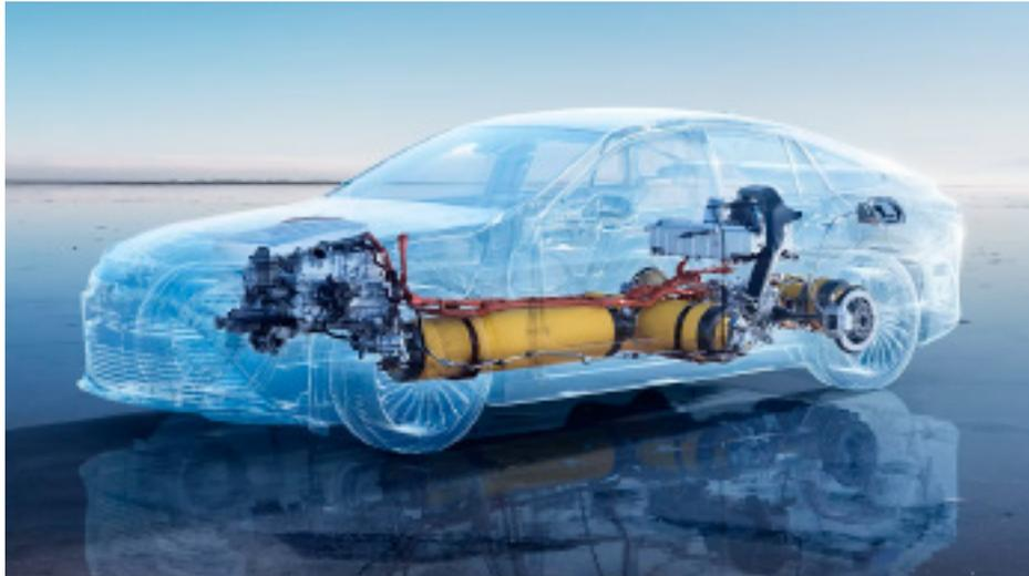
Figura 7: Automóvil eléctrico MIRAI 2023 de Toyota© basado en FC con una potencia eléctrica de 128kW[4]
