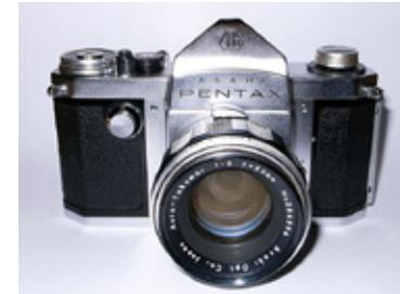
Todos los fabricantes se dedicaron a introducir el pentaprismo en sus modelos réflex y a incluir fotómetros integrados. Asahi Optical disponía de un fotómetro externo de Sulfuro de Cadmio (SCd) para los primeros modelos de Asahi Pentax, como ocurría con el modelo SV con el que Darío Podestá se inició en la Fotografía de Naturaleza y que se acoplaba al visor y dial de velocidades.
