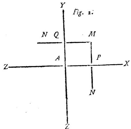
sur les axes  $AY$  et  $AX$  comme sur des charnières, et pouvant devenir perpendiculaires au plan  $YAX$ , auquel cas les deux axes  $AZ$  se réuniront pour n'en former qu'un seul perpendiculaire à  $YAX$ . Les axes  $AX$ ,  $AY$ ,  $AZ$
