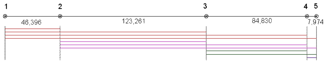
Figura 1: Distribución de las distancias (en metros) entre los 5 pilares.
