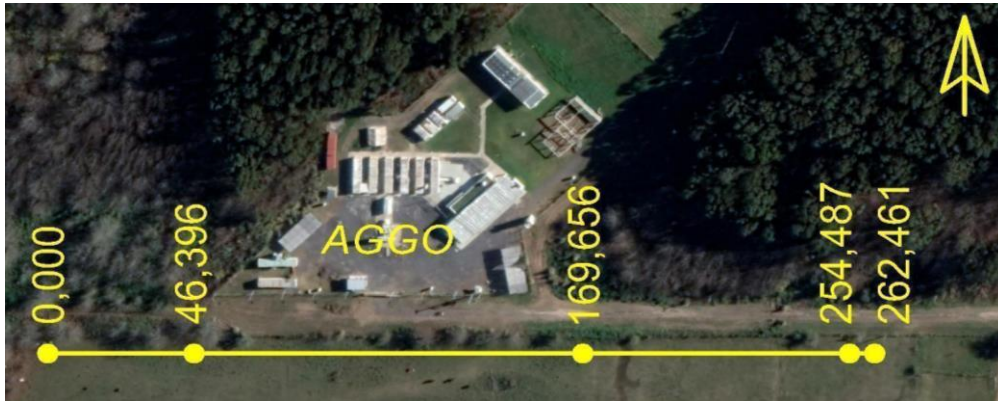
Figura 2 - Línea base transitoria utilizada; frente al observatorio AGGO.
