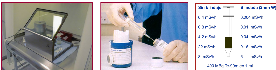
Figura 11.8. Blindajes para fraccionamiento.
