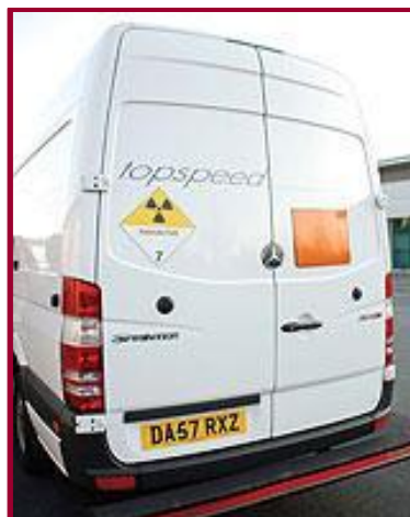
Figura 11.13. Rotulado del vehículo que transporta material radiactivo.
