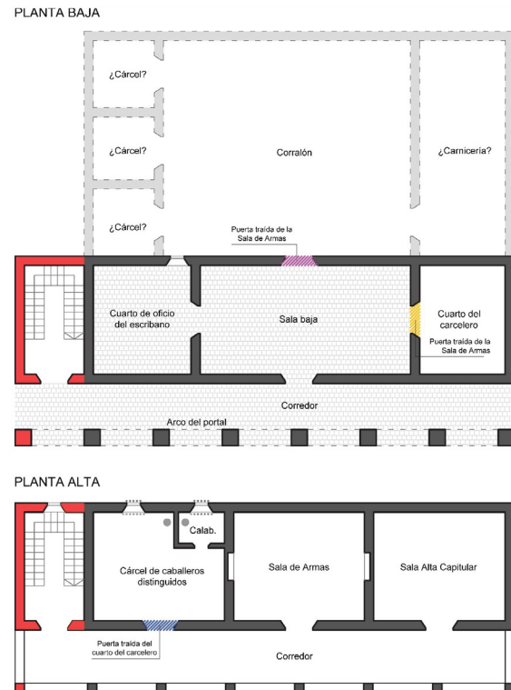
Figura 3. Reconstrucción hipotética de la planta del edificio principal del Cabildo de San Juan luego de la intervención realizada en 1781; en rojo se marca la sección de escalera y arco que se agregó al edificio y en rosa, amarillo y azul las puertas (Dibujo F. Chechi)
