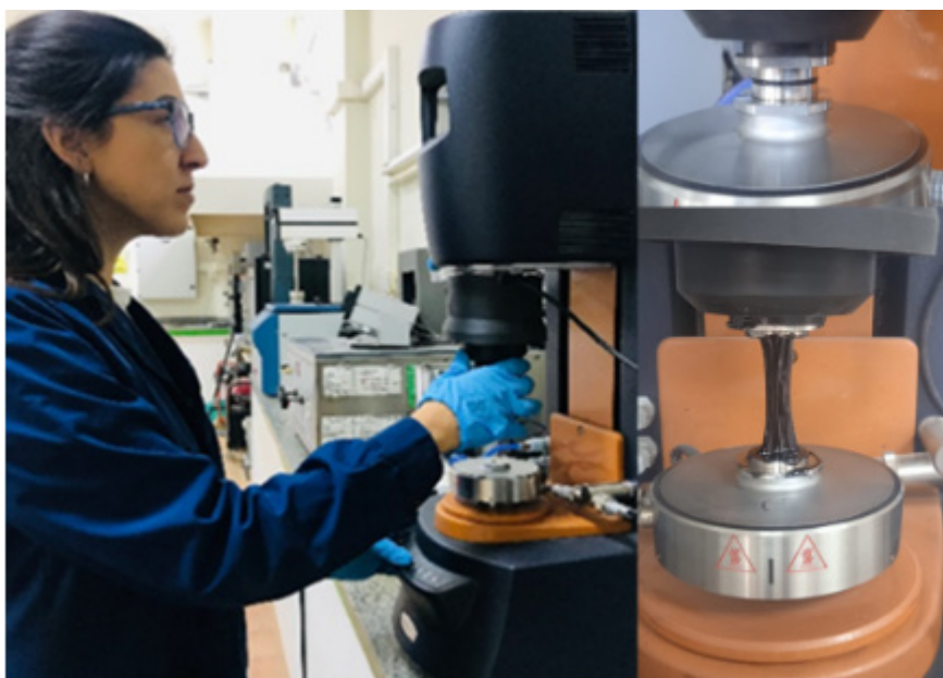
Figura 6. Reómetro de corte dinámico DSR.
