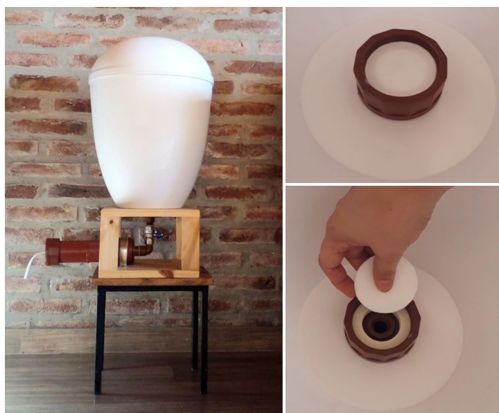
Figura 1. Sistema filtrante con capacidad de 20 litros instalado en vivienda particular del Gran La Plata. Figure 1. Filtration system with 20 liters loading capacity installed at a private home in Gran La Plata.
