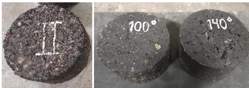
Figura 5. Probetas moldeadas con el pastón de pruebas del Grupo 1 (a) y del Grupo 2 y 3 (b) Figure 5. Specimens molded with the test paste of Group 1 (a) and Group 2 and 3 (b)
