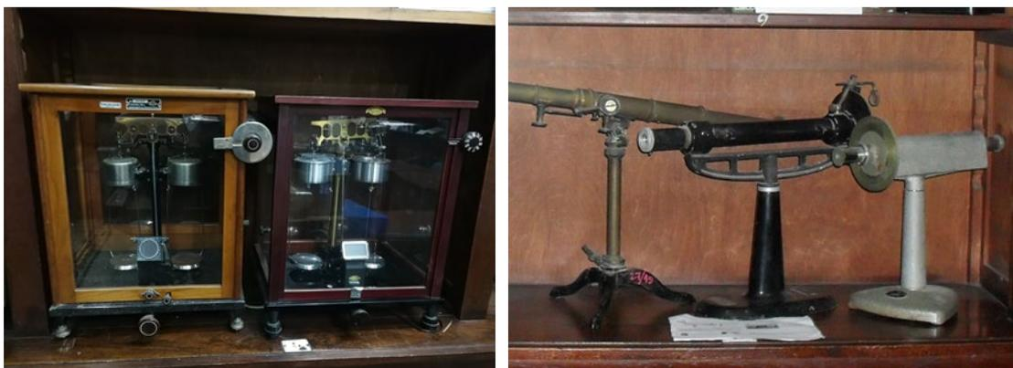
*Nota. Izquierda: Balanzas de uso analítico. Derecha: Dos tipos de polarímetros y un espectroscopio empleado en experimentos de óptica (Museo de Química y Farmacia "Dr. Carlos Sagastume").*
