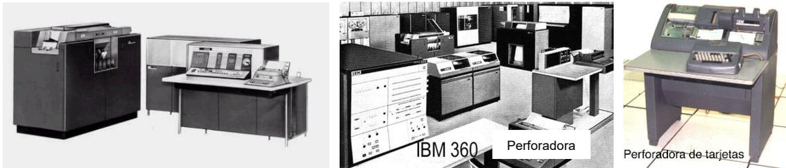
*Nota. Computadoras IBM 1620 (izquierda) similar a la existente en el Departamento de Matemática, IBM 360 (centro) y una unidad de perforación de tarjetas (1).*
