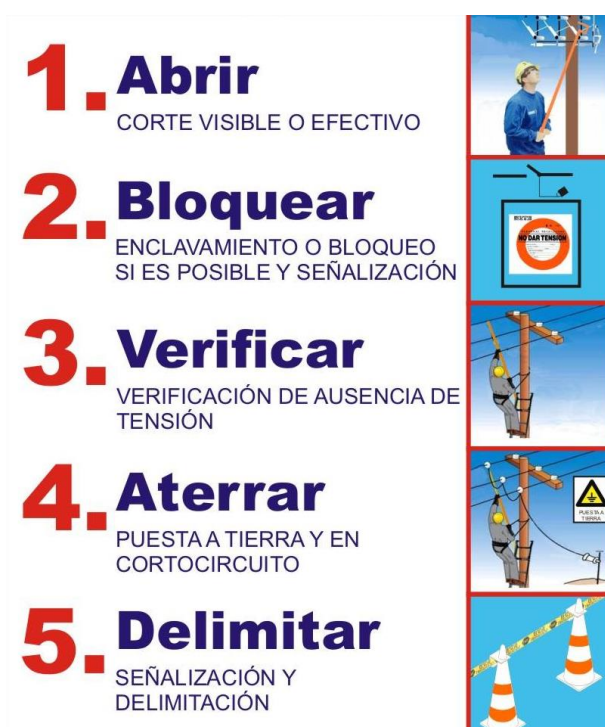
Imagen 9: 5 reglas de oro de la seguridad eléctrica
