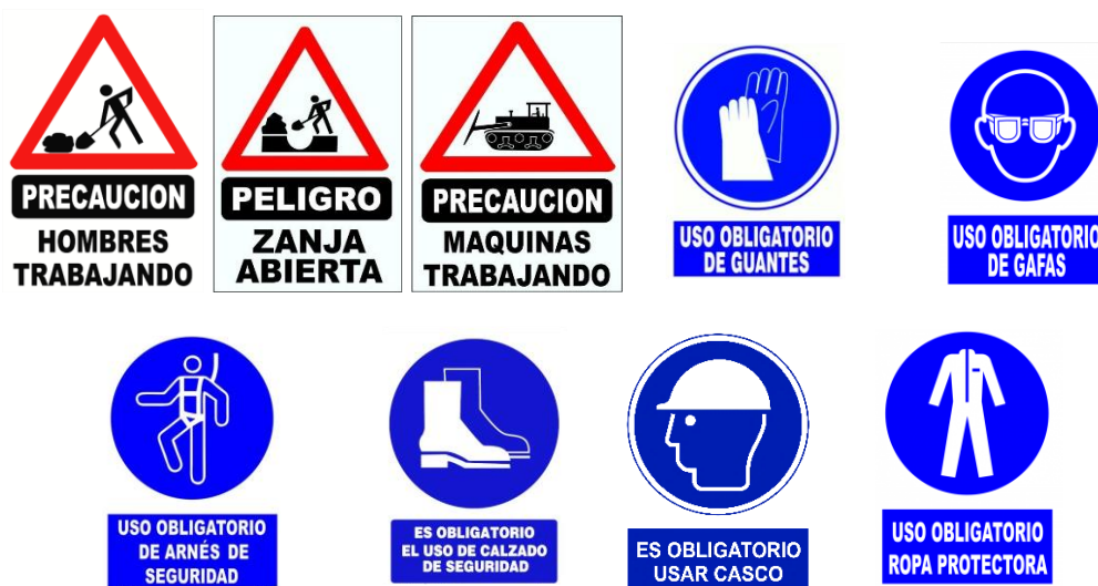
Imagen 6: Señaléticas a utilizar en proximidades de obra
