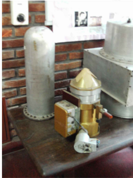
Figura 6 Adelante: el bolómetro de Galio-Germanio del proyecto ALIR. Detrás a la izquierda: detector de rayos X.
