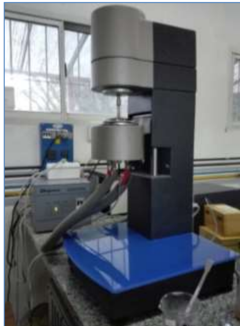
Figura 2.8. Medida de comportamiento reológico de las suspensiones filmogénicas. Reómetro oscilatorio. Facultad de Ingeniería (UNLP).
