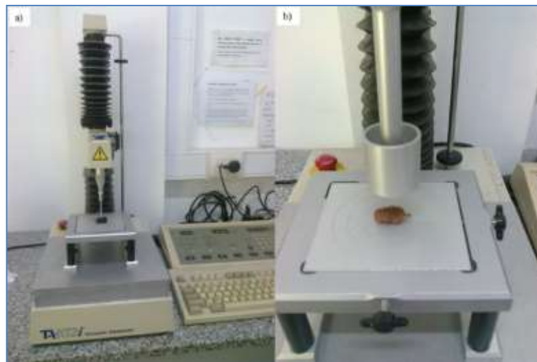
Figura 2.5. Fotografías del texturómetro mostrando las sondas utilizadas:
