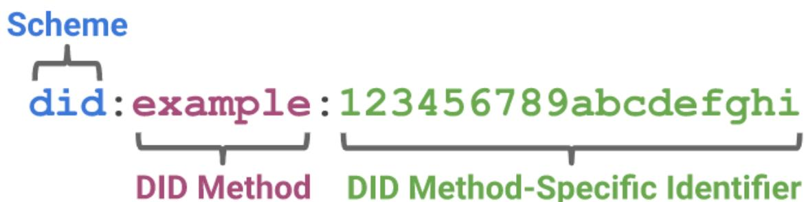
Ilustración 8 - Ejemplo de un DID y sus estructura resaltada
