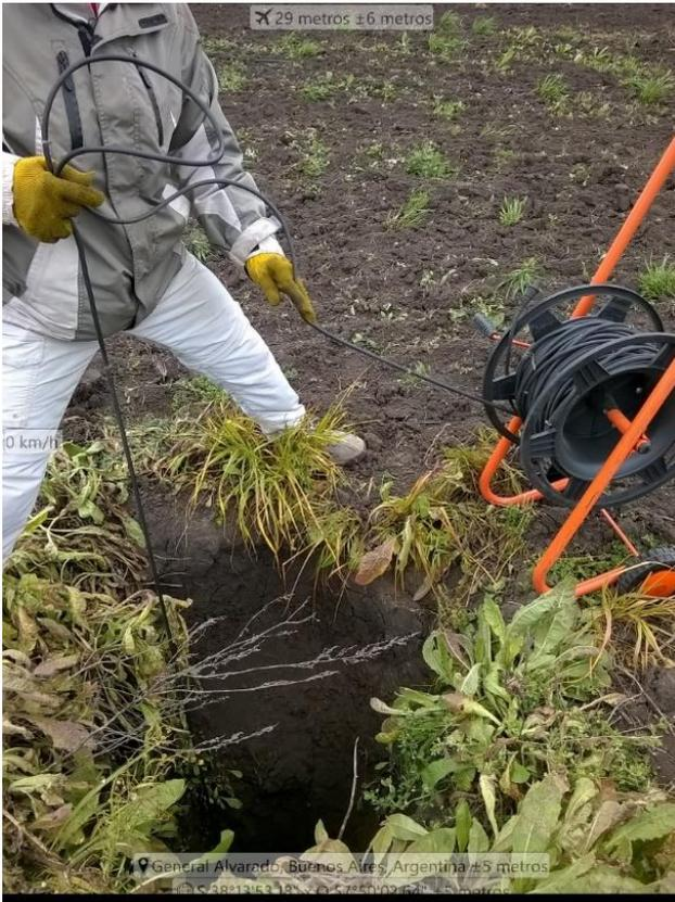
Figura 81. Realizando perfil de conductividad en pozo de riego.
