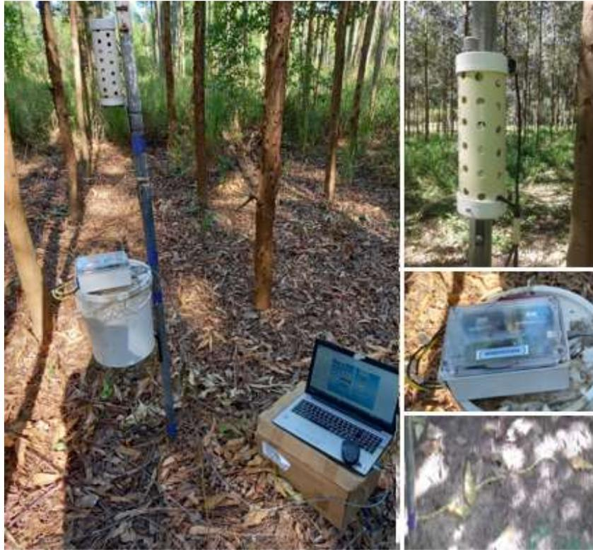
Figura 2. Colector climático de 4 canales (temperatura y humedad ambiente, temperatura y humedad suelo) instalados en los tratamientos de alta, media y baja densidad de plantación (AD, MD, BD).
