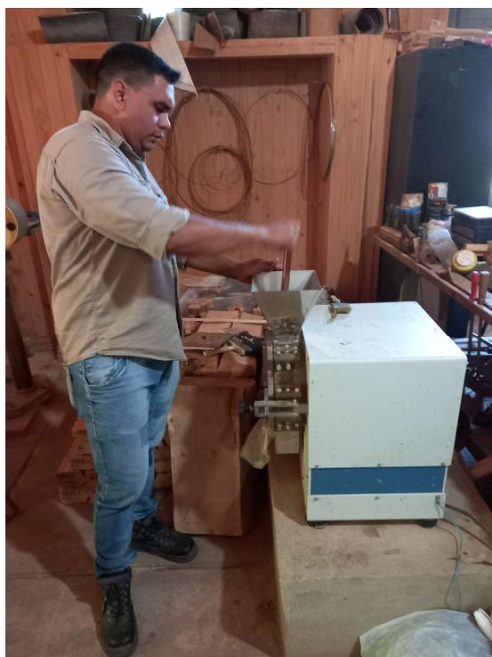
Figura 2. Molienda de muestras de biomasa para determinación de contenido de nutrientes. Foto: A. Maggio.
