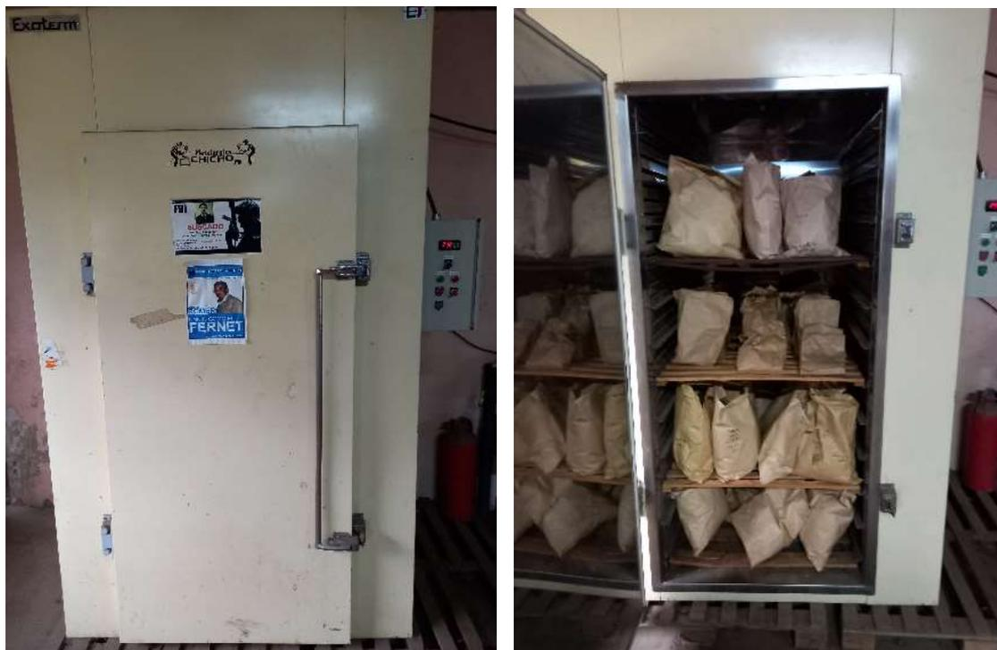
Figura 7. Muestras de biomasa aérea de *E. grandis* en estufa de secado.
