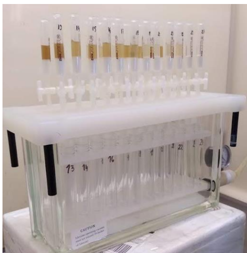
Figura 9: Columnas Strata® NH 2 (Phenomenex, EEUU) asociadas a un equipo de vacío para la remoción de H 2 SO 4 de los hidrolizados de levaduras.
