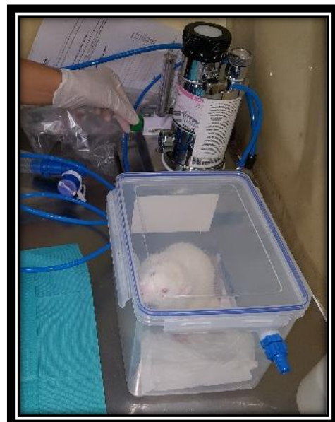
Fig. 27. Equipo de anestesia inhalatorio con un animal ya en la cámara.
