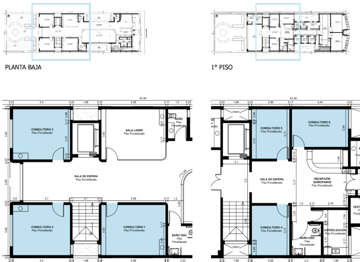
Figura 3: Planta de consultorios (planta baja y 1º piso). Fuente: Elaboración propia a partir de los planos elaborados por estudio de arquitectura BACA
