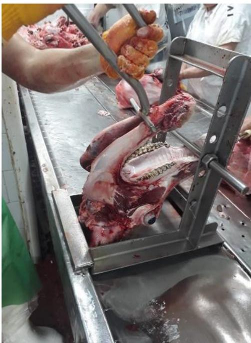
3. El operario acciona la palanca descalzando la articulación témporo-mandibular (Figura 8).
