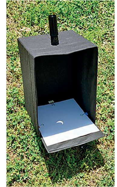
Cámara oscura para observación de eclipses solares.
