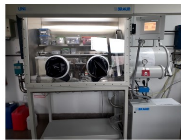
Figura 23: Caja de guantes MBraun UNILab.
