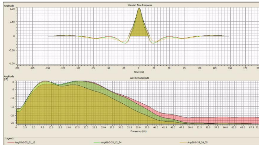
Figura 37: Ondículas promediadas según rango de ángulos. Juntas forman la ondícula grupal.
