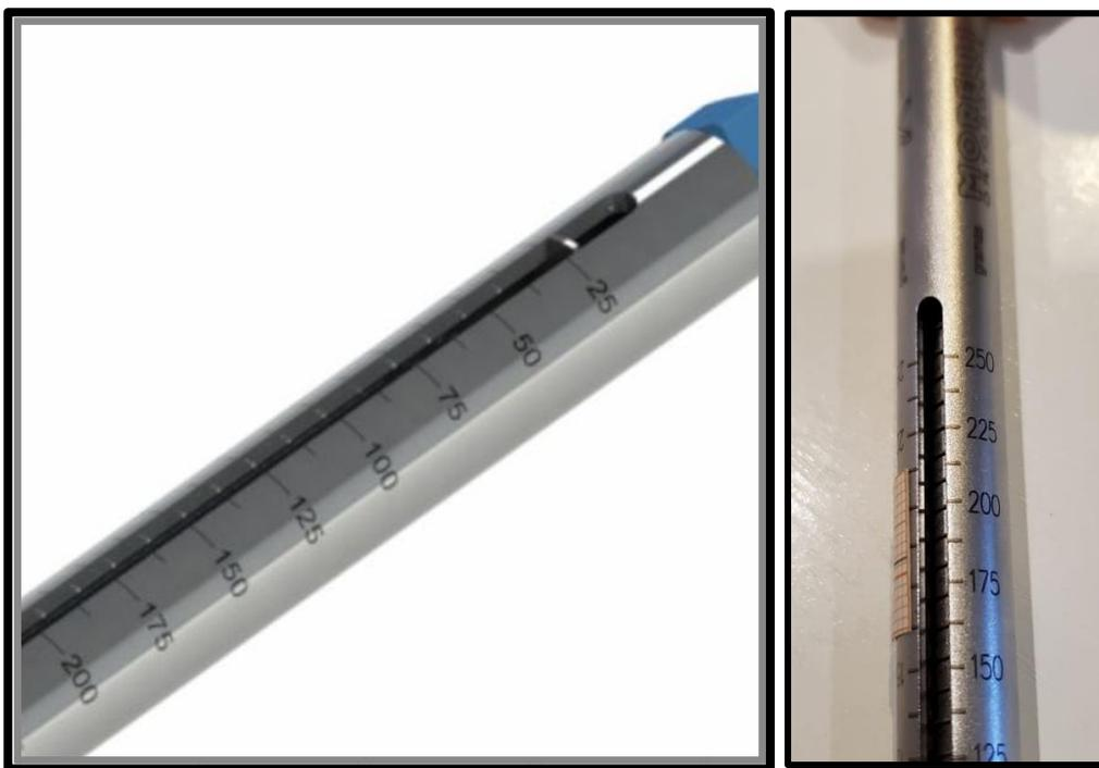
Fig. N° 18. Marcas del fabricante cada 12.5 gf equivalente a 3.75 mm.
