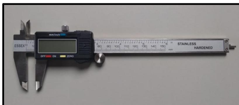
Fig. N° 16. Calibre electrónico digital con coliza de la marca ESSEX®
