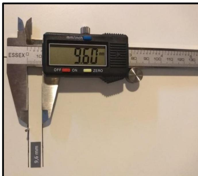
Fig. N° 19. Distancia correspondiente a tres veces el diámetro inicial del elástico a estudiar.
