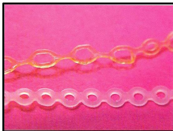
Fig. N° 11. Comparación de una cadena nueva con una cadena usada (un mes de uso)
