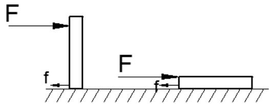
Figura 3: Comportamiento de un bloque según sus diferentes superficies de contacto.
