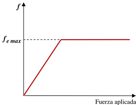
Figura 2: Gráfico de la fuerza de rozamiento en función de la fuerza de frenado, en un sistema con Abs.
