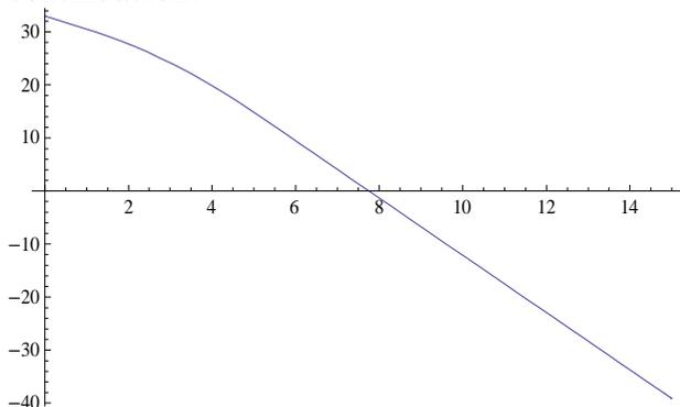
Figura 8: Gráfico de la velocidad del auto con Abs.
