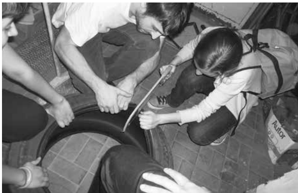
Alumnos preparando moldes para colar cemento
