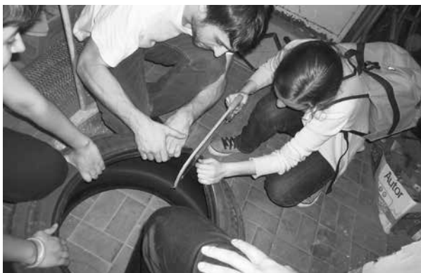
Alumnos preparando moldes para colar cemento
