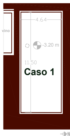
Figura 1: Planta de la vasija de vinificación correspondiente al Caso 1. Se observa que el mismo no colinda con otras celdas vinarias, sino que se halla en contacto directo con el terreno natural.
