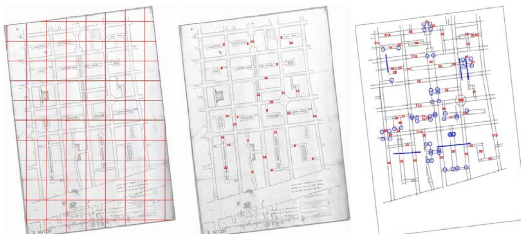
Figura 4. Transcripción y análisis de la forma proyectada. De izq. a der.: a) Retícula de coordenadas de la lámina (100m.) ; b) Cotas de anchos de calles en lámina; c) estudio del Trazado regulador y anchos de calles utilizados, Empalmes en ángulo recto y Relaciones de paralelismo.
